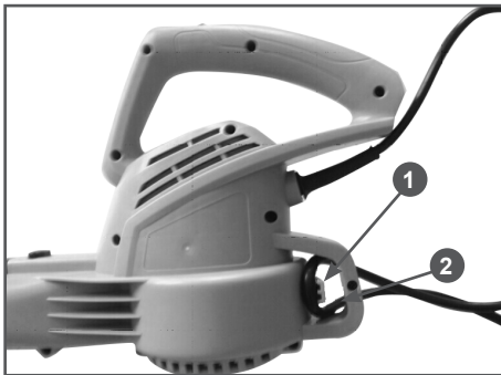
Рис. 3 Крепление кабеля удлинителя на корпусе воздуходувки
