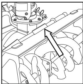
**Примечание!** В случае если желоб забит снегом, прочистку желоба следует производить специальным инструментом.
